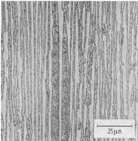
Bild 2.7. Lamellares Gefüge im Querschliff des Blattes einer gerichtet erstarrten Turbinenschaufel aus einer Nickelbasislegierung (Archiv mtu)
